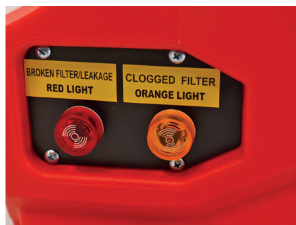
Tydlig info med LED-lampor och ljudsignal som larmar vid nedsatt filterstatus
